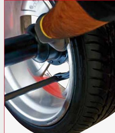
Neue digitale Messlehre für Durchmesser- und Abstandmessung mit integrierter FSP (Fast Selection Program) Funktion und neuem, integriertem LaserBlade Pointer: die Funktion FSP aktiviert automatisch die Auswuchtprogramme und erfordert deshalb keine Wahl über die Tastatur mehr. Der LaserBlade Pointer (im Messarm) unterstützt den Bediener bei der Wahl der Innenflächen der Leichtmetallfelge - fehlerfrei und mit extrem gutem Sichtfeld.
