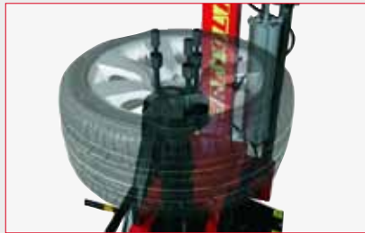
Universal flange for special rims (for manual wheel clamping version) Bride universelle pour jantes spéciales (pour version avec blocage manuel) 8-11100087
